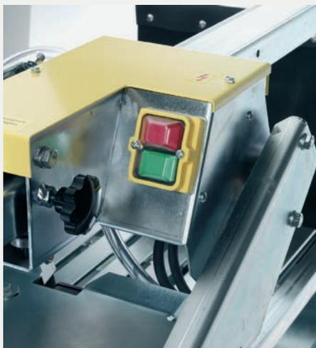
Integrierter versenkter Schalter und mehrfach gelagerter Wippschalter sichern Langlebigkeit und hohe Funktionalität.
