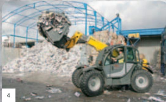
Einfälle für Abfälle: Allradgelenkte Radlader, Teleradlader und Teleskoplader verfügen für Arbeiten auf engstem Raum über die erforderliche Wendigkeit – kombiniert mit kompakten Abmessungen und niedrigen Betriebskosten der Schlüssel zur Wirtschaftlichkeit.
