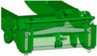
Gerätenbauplatte mit elektrohydr. Entriegelung
