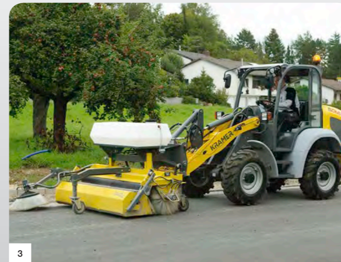
2 Mulcheinsatz mit powerflow Leistungshydraulik 3 Kehrmaschineneinsatz mit effizientem 3. Steuerkreis (serienmäßig)
