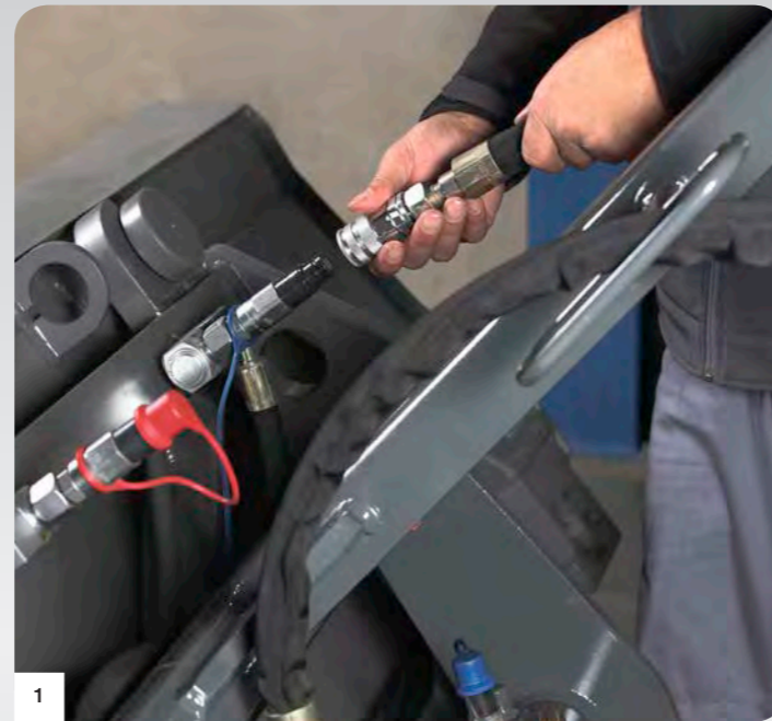
1 Einfache und sichere Anbindung des Anbaugerätes
